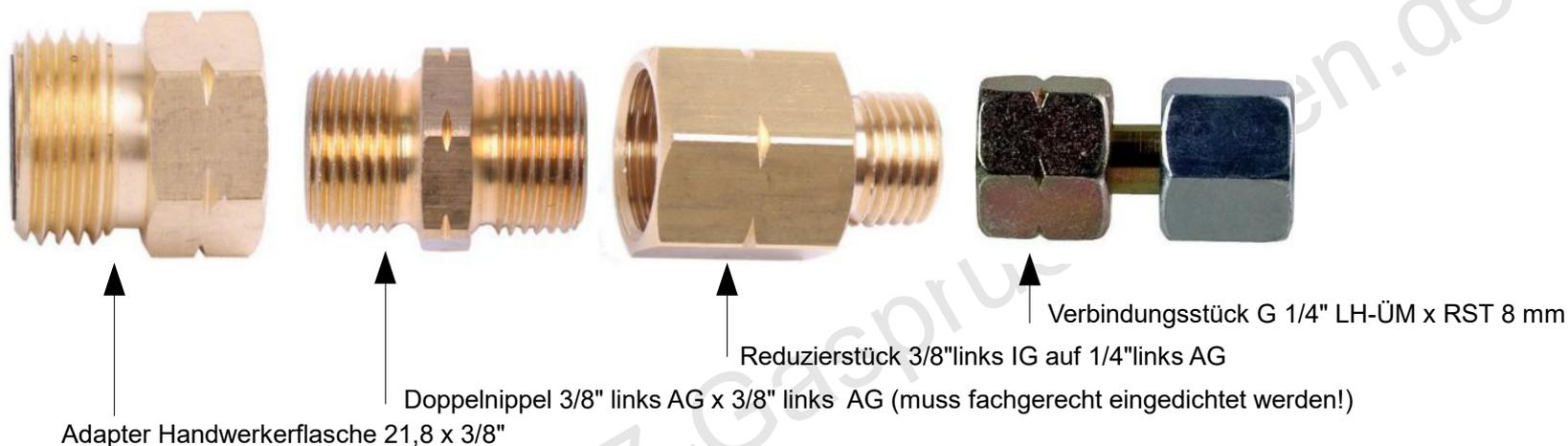
Adaption bietet Anschlussmöglichkeit für Schlauch mit 3/8" links, 1/4" links und RVS8
